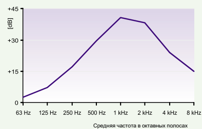
Внутреннее шумопоглощение шумоглушителя
